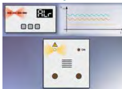
Традиционное устройство контроля изоляции
