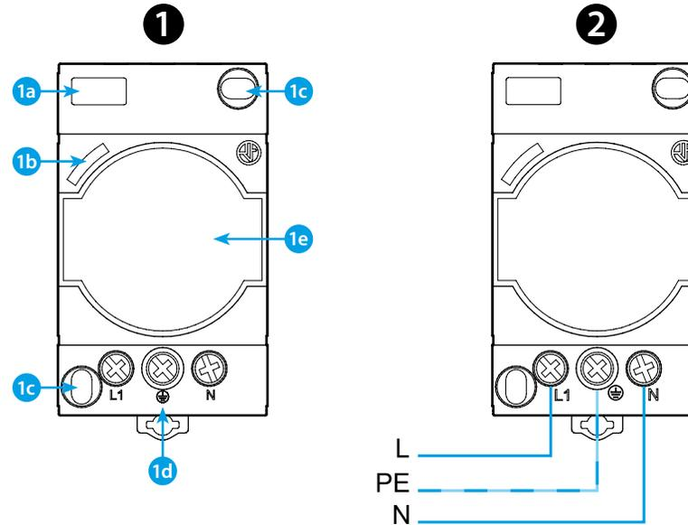
7U ЭЛЕКТРИЧЕСКАЯ РОЗЕТКА ДЛЯ МОНТАЖА НА РЕЙКУ ИЛИ НА ПАНЕЛЬ ДЛЯ ИСПОЛЬЗОВАНИЯ В ЭЛЕКТРИЧЕСКИХ ШКАФАХ
