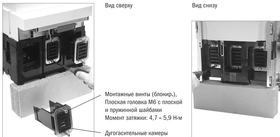
Рисунок 43. Монтажные винты дугогасительной камеры 42
