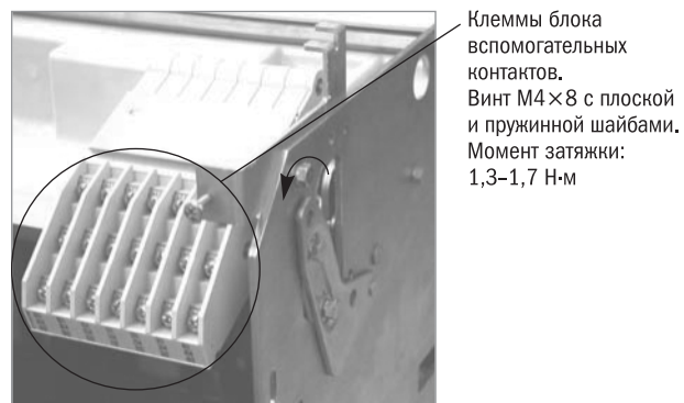
Рисунок 10. Перемещение клеммной колодки вниз
