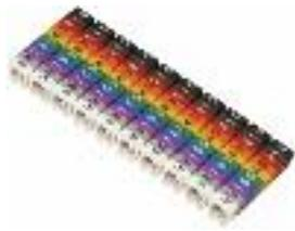
Маркеры серии МКН могут быть установлены во время монтажа проводки, в том числе после оконцевания и соединения проводника. Имеющиеся пазы позволяют маркировать проводку длинными надписями. Маркеры МКН в процессе эксплуатации устойчивы к воздействию температуры в диапазоне от минус 30 до плюс 70 °С. Монтаж маркеров МКН должен осуществляться в диапазоне рабочих температур от минус 10±2 °С до плюс 50±2 °С.
