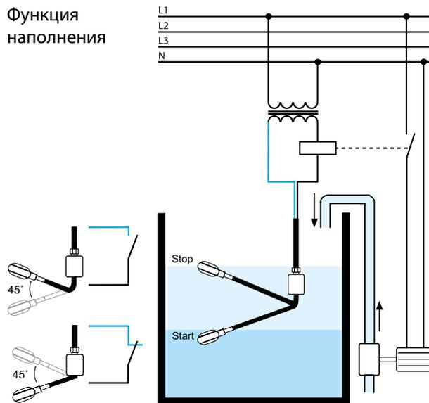
При подключении черного и синего/серого проводов, схема размыкается, когда поплавок движется вниз, и закрывается, когда поплавок движется вверх.
