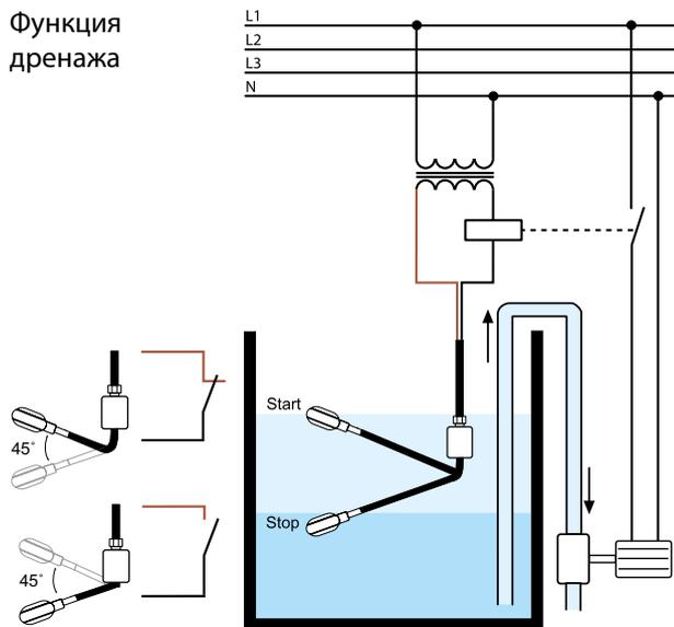
При подключении черного и коричневого проводов, схема размыкается, когда поплавок движется вниз, и закрывается, когда поплавок движется вверх.
